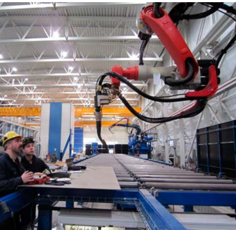
Gjennom robotisering bygger Kleven Verft en større del av skipsskrog i Norge.
