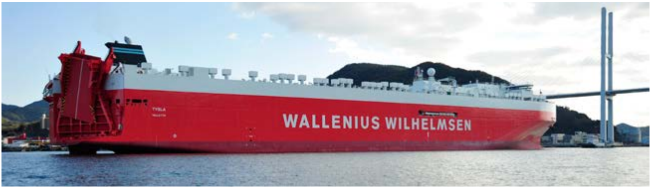
Ro-Ro skipet «Tysla» er designet for effektiv transport og håndtering av biler, høy og tung last. Norske rederier er ledende i spesialiserte skipsfartssegmenter.
