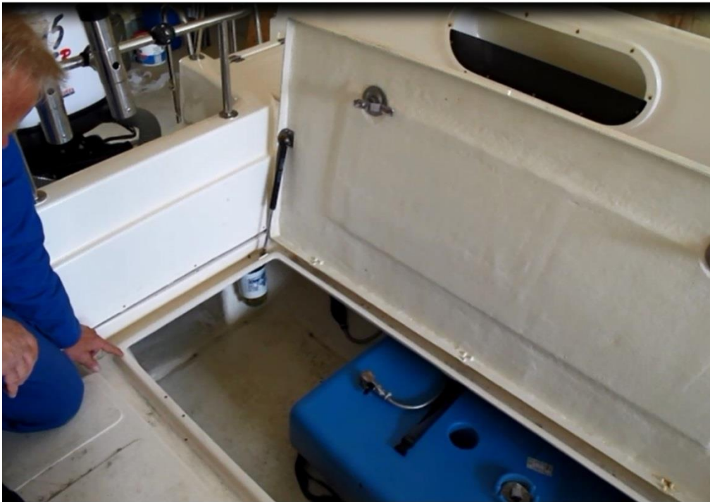
Figur 5 Bildene er tatt av ulykkesbåten i etterkant av ulykken. Det øverste bildet viser åpning mellom dørk og dreneringskanalene. Det nederste bildet viser luken som åpnet. Lukekarmen er 20 mm lavere enn dørken. Luken er ikke vær eller vanntett. Foto: SHT
