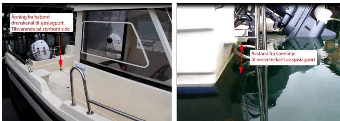
Figur 3 Bildene er tatt av søsterbåten. Bildet til venstre viser dørkluken. Denne ligger i kant med dørken. Rundt dørkluken er det drengkanaler og åpning til babord og styrbord sjøslagport. Bildet til høyre viser babord akterspeil og kant til sjøslagport. Bildet er tatt med en person om bord. Foto: SHT
